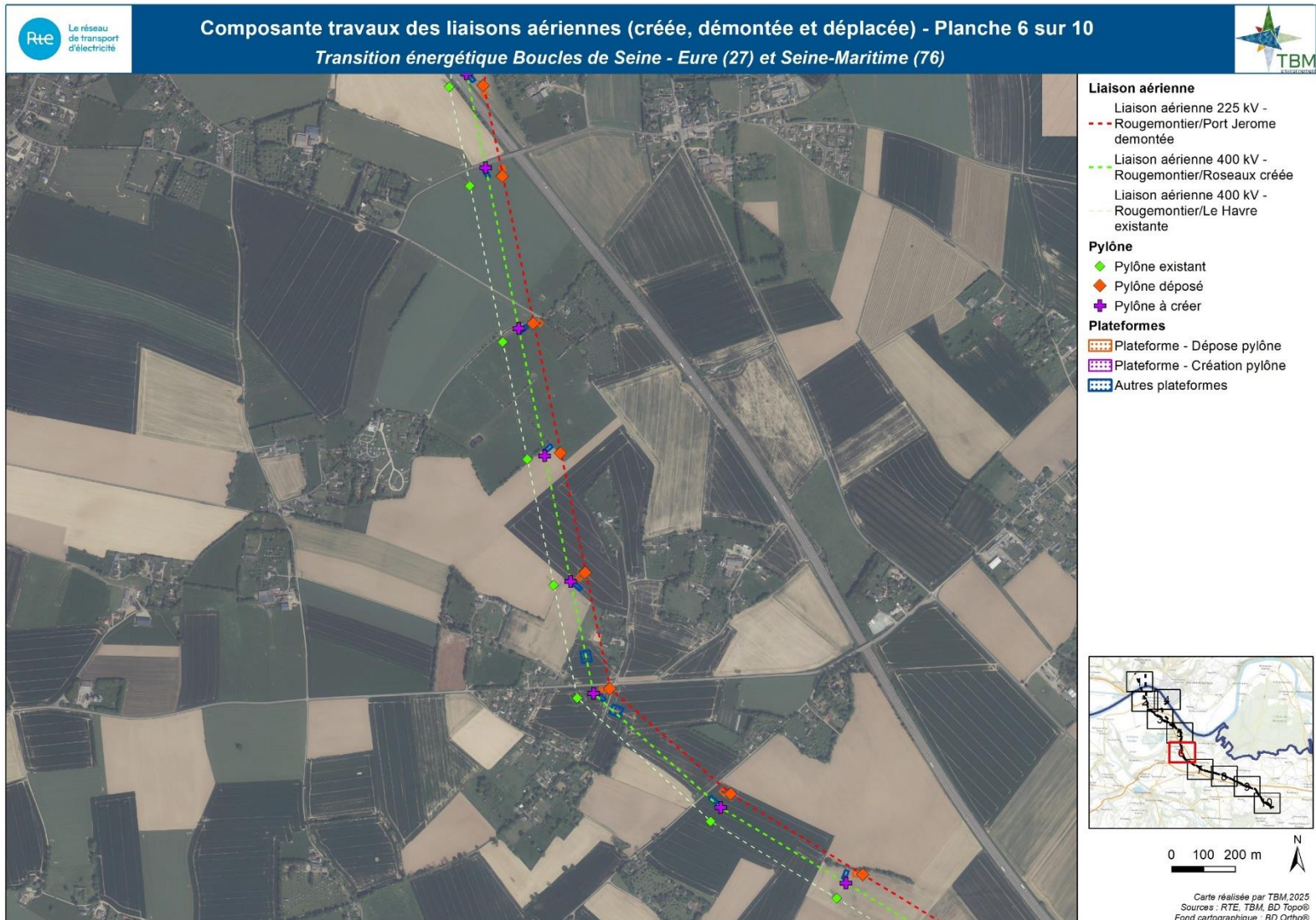
Figure 16 : Localisation des pylônes démontés 6/10
