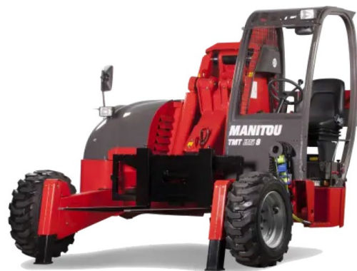
Exemple de chargeur embarqué destiné à la collecte des caisses-palettes
