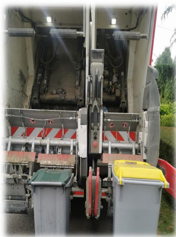
*Une benne bi-compartmentée permet la collecte simultanément des ordures ménagères résiduelles et les déchets valorisables.*
